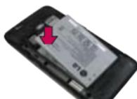
**2** Alinee los contactos de la batería con los terminales en el compartimiento de la batería y empuje la batería hacia abajo hasta que encaje en su lugar.
