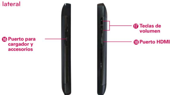
16. **Puerto para cargador y accesorios** permite conectar el cargador, el cable USB u otros accesorios compatibles.
