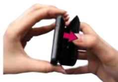
2. Retire la batería del compartimiento de la batería usando la abertura de dedo y levantando la parte superior de la batería.
